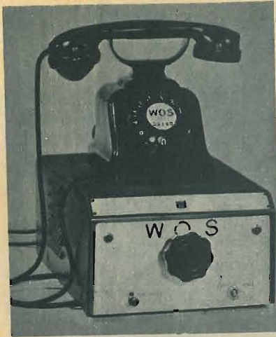
Complesso WOS a risposta automatica. A sinistra: l'apparecchio telefonico automatico sovrapposto e collegato al complesso (chiuso). A destra il WOS aperto: comprende il piatto grammofonico, l'amplificatore e gli organi di comando. Sotto la sigla WOS la manopola di preselezione delle risposte.
